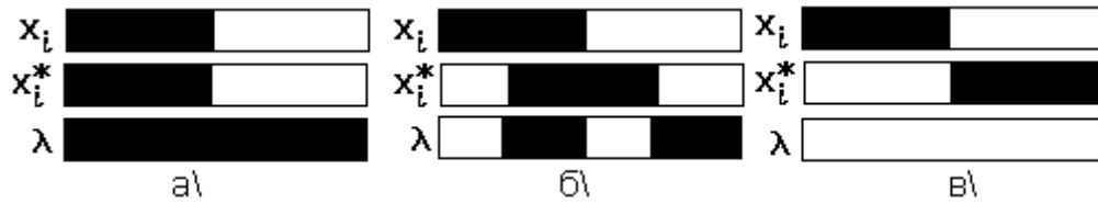
рис. 25. Функция равнозначности \lambda для разных случаев величины задержки *: а) задержка равна нулю б) задержка равна T/4 в) задержка равна T/2
